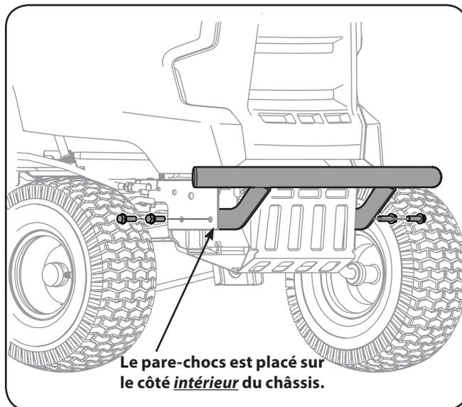
Le pare-chocs est placé sur le côté intérieur du châssis.
